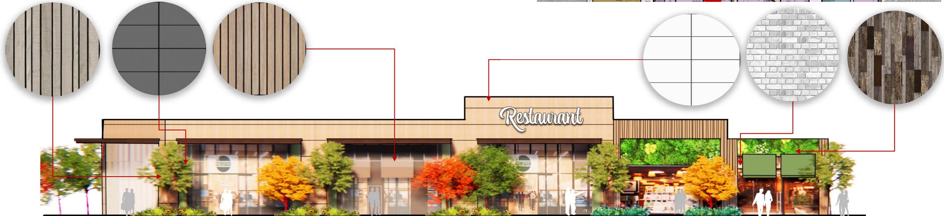
F06 FACCIATA 06 – Pannello in alluminio bianco e grigio e pannello in legno ceramico – Green Wall – Pannello in fibrocemento
