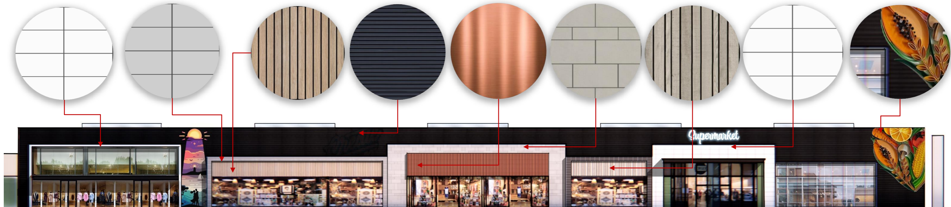
F04 FACCIATA 04 – Pannello in alluminio bianco e grigio e pannello in legno ceramico – Arte murale dipinta su rivestimento di facciata metallica – Pannello in fibrocemento – Pannello di lamiera in rame
